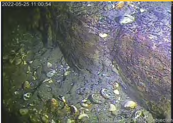
Vermoedelijke kielbalk met schuine las. (Foto: ADC/Baars-CIPRO)
