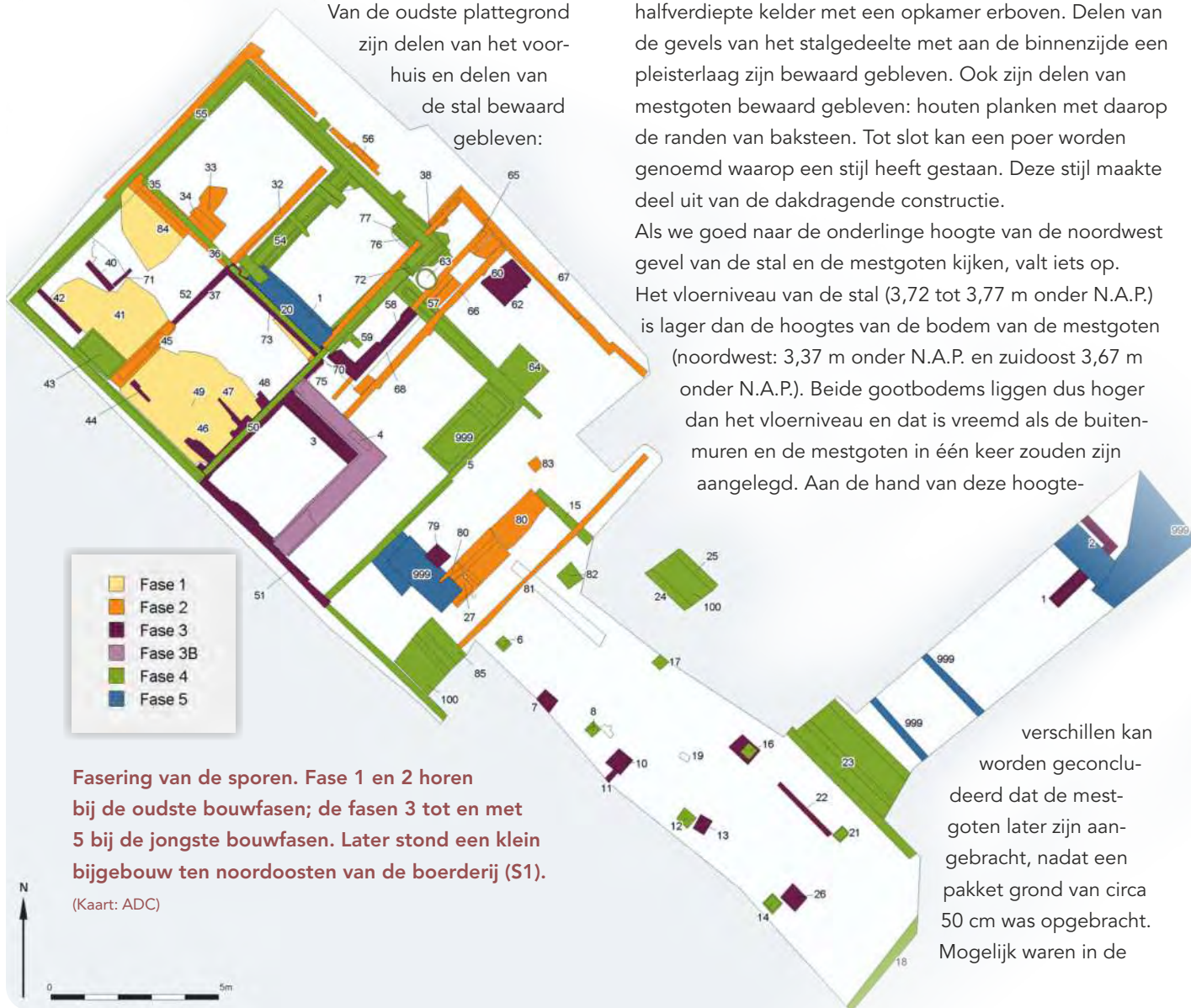
Reconstructie van de boerderijplattegrond, bouwfases 1 en 2. De kruisjes in het stalgedeelte staan ter hoogte van vermoede poeren; de rode lijn geeft de locatie van de doorsnede in afbeelding 10 weer. K=kelder; G=mestgoot. (Tekening: ADC)
