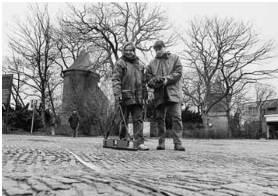
Afb. 31. Schagen * Slot van Schagen. Weerstandsmetingen ter plaatse van het Slot van Schagen (foto: John Oud, Winkel NH).
